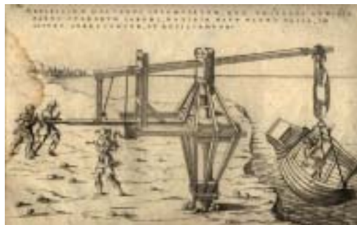
Machine pour soulever un bateau
