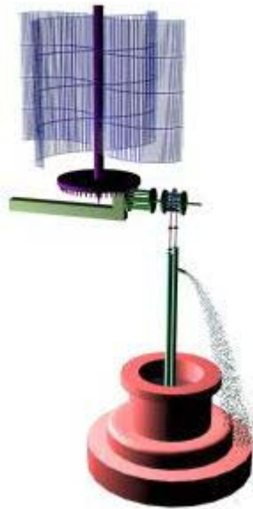
Moulin à vent actionnant une noria
