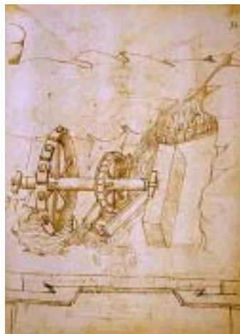
Canal d'irrigation alimentant une roue hydraulique tirant une roue à godet
